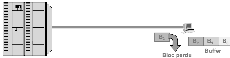
Figure 4.35 Nécessité d'instaurer un contrôle de flux.
