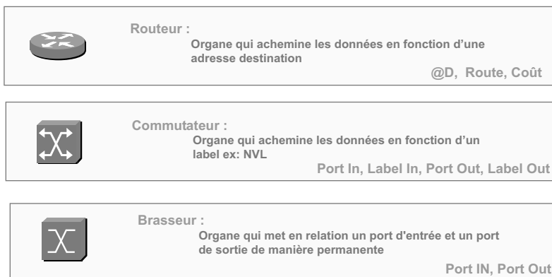
Figure 6.55 Routeur, commutateur, brasseur.
